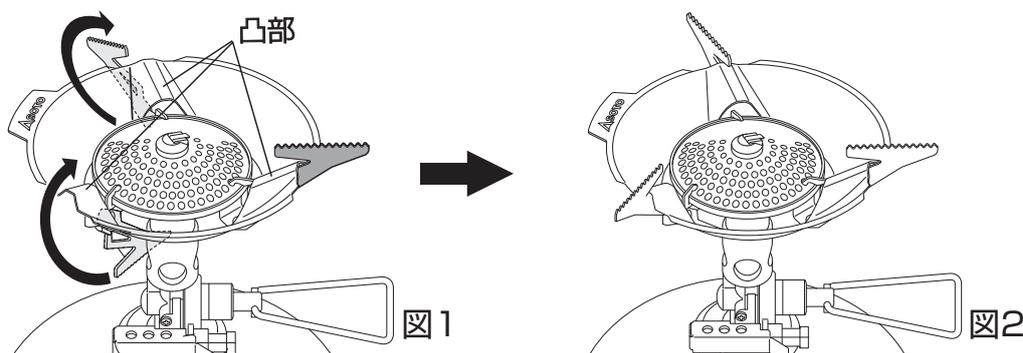
2.ゴトクを1本のみセットした後、ウインドスクリーンの凸部(3つの凸部のどれでも可)をセットしたゴトクにのせます。(図1) 残り2つのゴトクをウインドスクリーンの各凸部に合わせてセットします。
