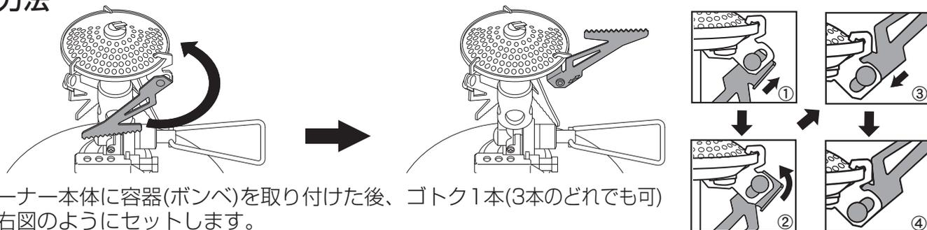
1.バーナー本体に容器(ボンベ)を取り付けた後、ゴトク1本(3本のどれでも可)を右図のようにセットします。
